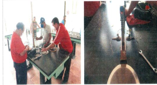
F24: Unidad verificadora y pruebas de gas en llaves de mesas de laboratorio
